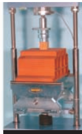
Продавливание керамических блоков
