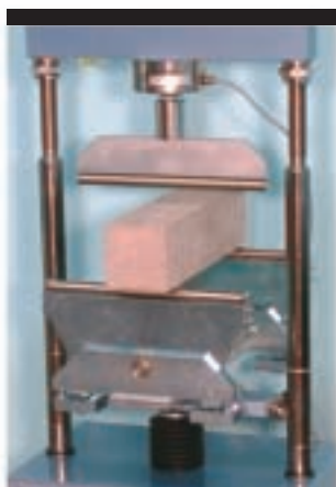
Изгиб бетонных балочек
